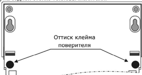
Рис. 1.2 – Места пломбирования поверителем
